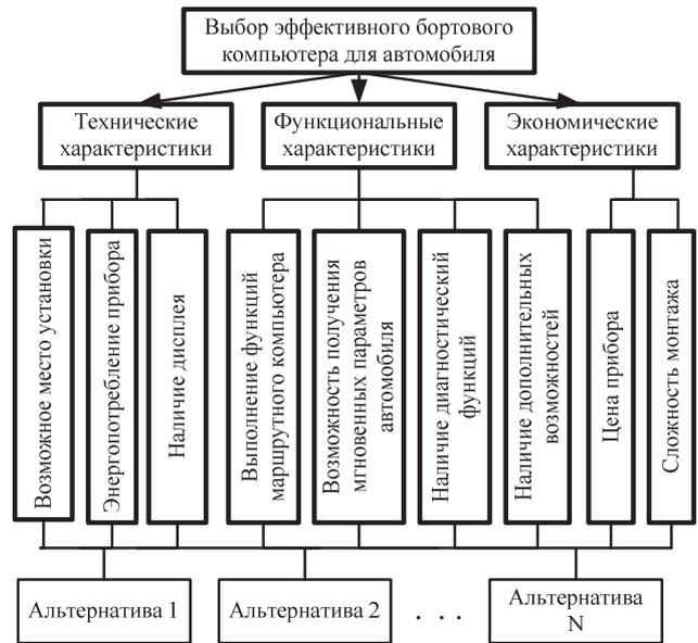
Рис. 1. Обобщенная модель выбора эффективного БК для автомобиля
