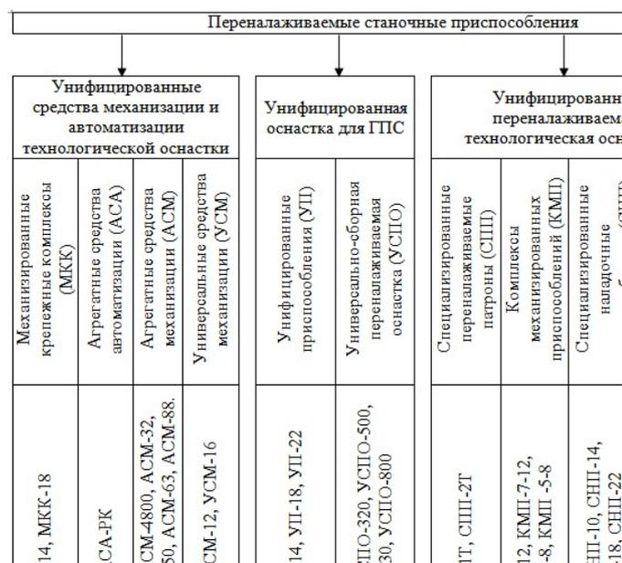
Рис. 1. Структурный состав переналаживаемых станочных приспособлений
