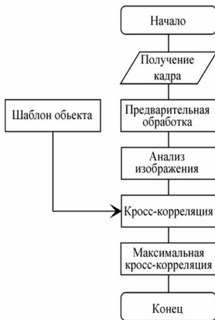
Рис. 2. Алгоритм поиска объекта с использованием кросс-корреляции [7]
