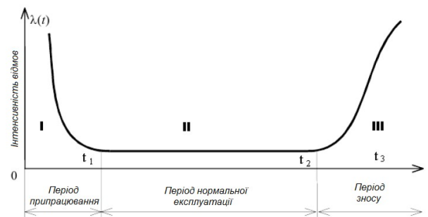
Рис. 1. Ідеалізована «крива життя» виробів радіоелектроніки
