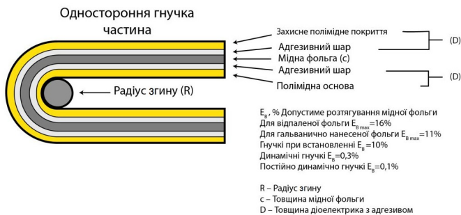
Рис. 6. Одношарова ГС із захисним поліімідним покриттям і адгезивним шаром
