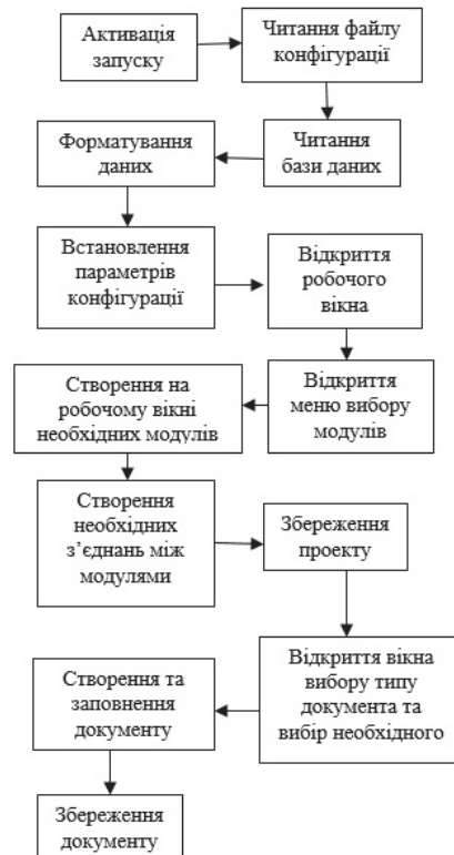
Рис. 4. Послідовність дій під час проектування модульної конструкції РТЗ
