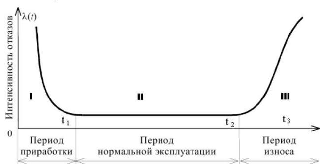
Рис. 1. Идеализированная «кривая жизни» изделий радиоэлектроники
