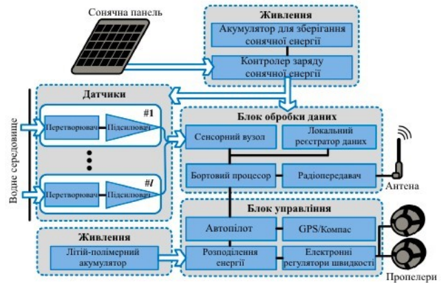
Рис. 2. Структура мобільних сенсорних вузлів
