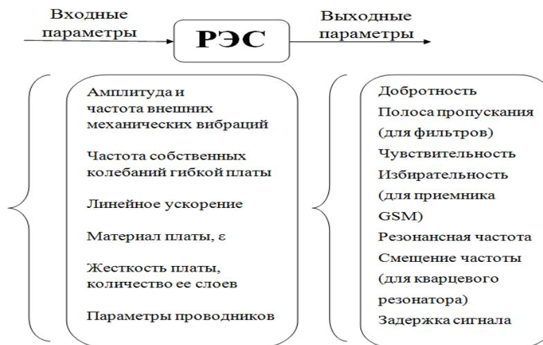
Рис. 4. Параметры РЭС для построения системологической модели
