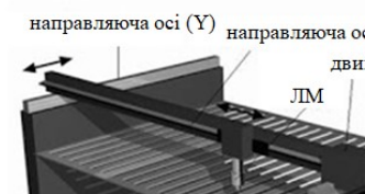
Рис. 8. Схема роботи лазерного верстата з пересуванням ЛМ в двох осях
