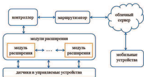
Рис. 1. Схема аппаратного обеспечения умного дома с функцией удаленного управления [3]
