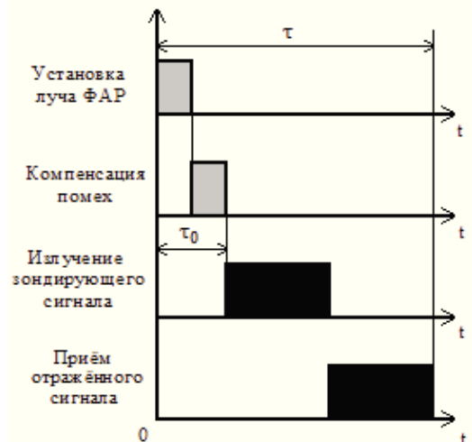
Рис.1. Такт измерения координат сопровождаемой цели
